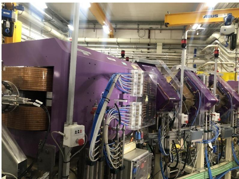
Figure 4 : Vue d'un dispositif de guidage au premier plan et de quadripôles de focalisation au deuxième plan. Photo Ae
